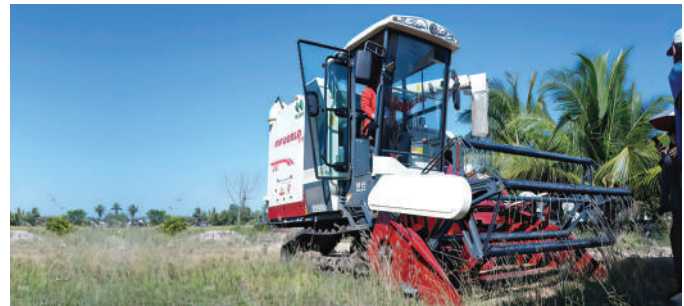
Rajah 15: Jentera yang digunakan untuk menuai padi
